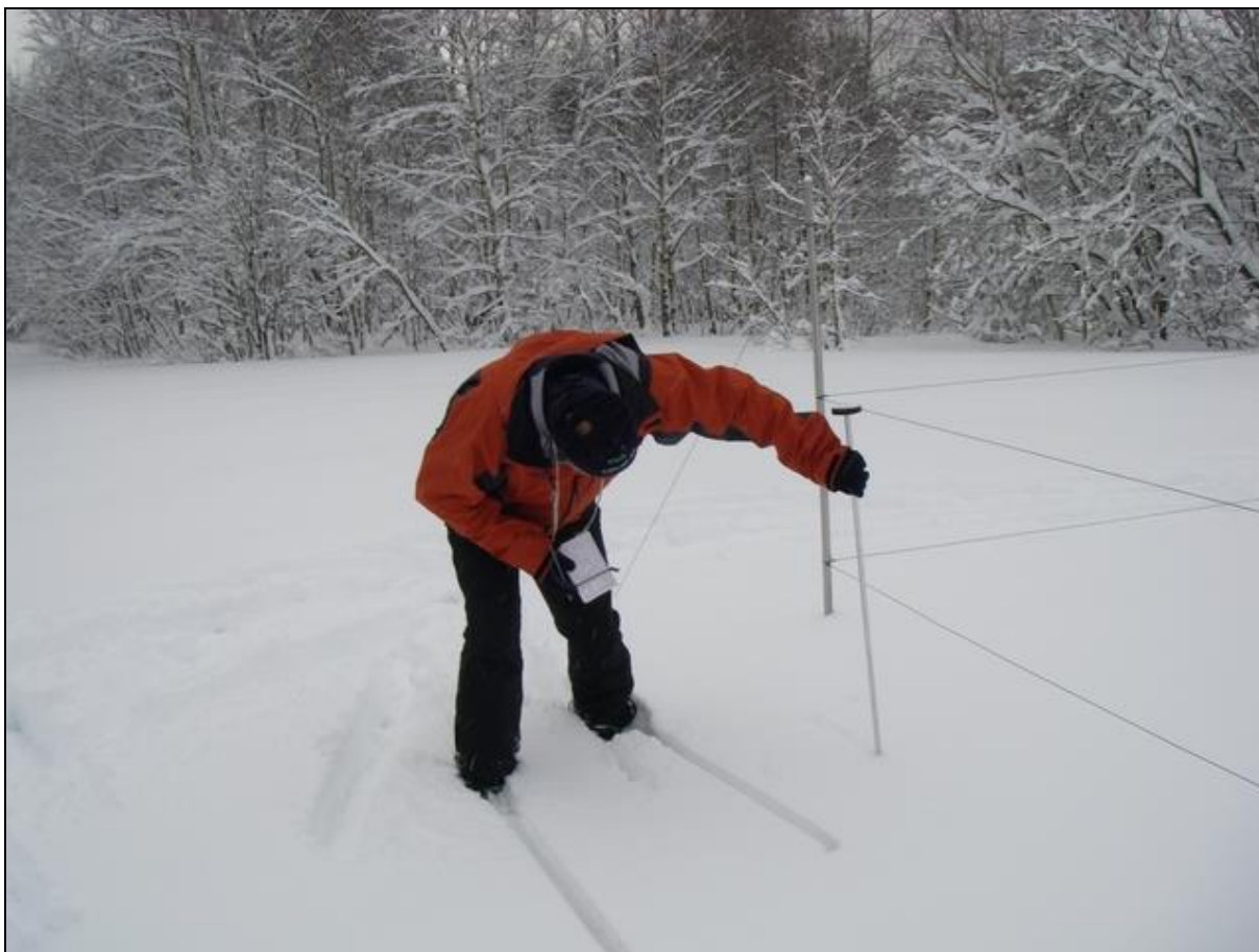
Pravidelné kontrolní ruční měření prováděné po okrajích sněhoměrného polštáře typu Sommer.
