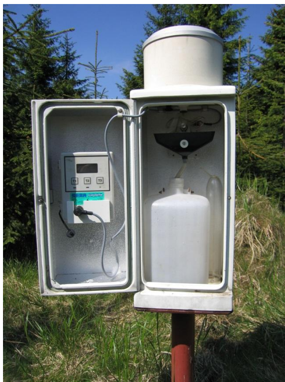
6.14 Srážkoměr Seba se záchytnou plochou 20 cm 2 s totalizací a registrační jednotkou RDS
