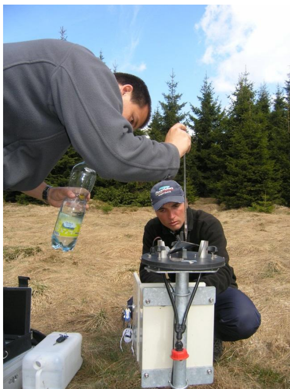
6.16 Kalibrace srážkoměru při osazení v terénu. Pravidelně probíhá kontrola totalizovaných úhrnů a zaznamenaných hodnot.
