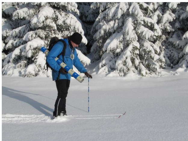
6.20 Pravidelné manuální měření výšky a vodní hodnoty sněhové pokrývky slouží pro hydroprognózu .
