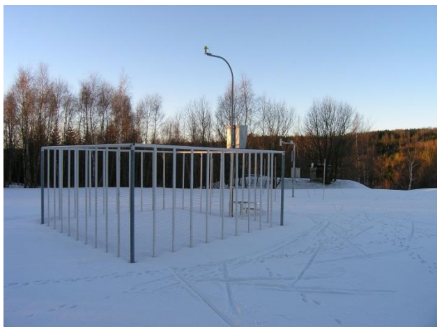
6.19 Další testovaný typ sněhoměrného polštáře je v provozu u klimatické stanice Souš.
