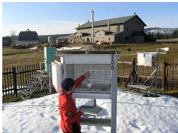
6.10 Kromě moderní měřicí techniky je na stanici i budka s klasickými teploměry.
