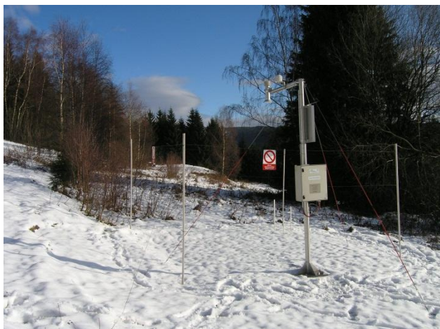
6.17 Automatické měření výšky a vodní hodnoty sněhu – lokalita Hanapetrova paseka v Krkonoších
