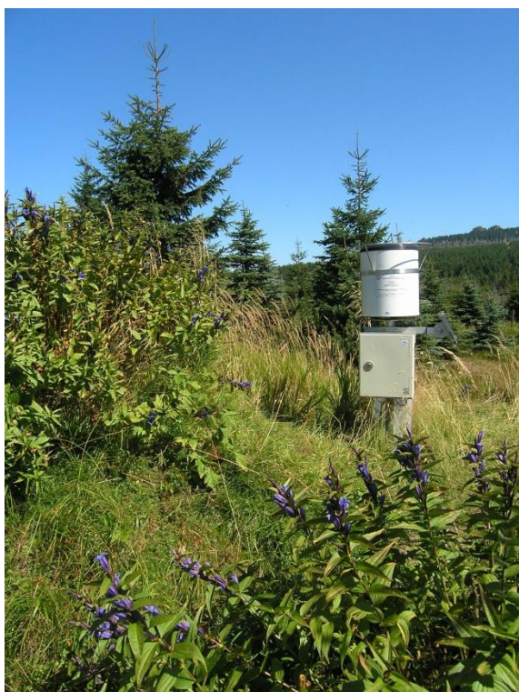
6.15 Srážkoměr v lokalitě Knajpa, srážkoměr MR 3 se záchytnou plochou 50 cm 2 a dálkovým přenosem dat. Měření jsou přístupná na stránkách ČHMÚ.
