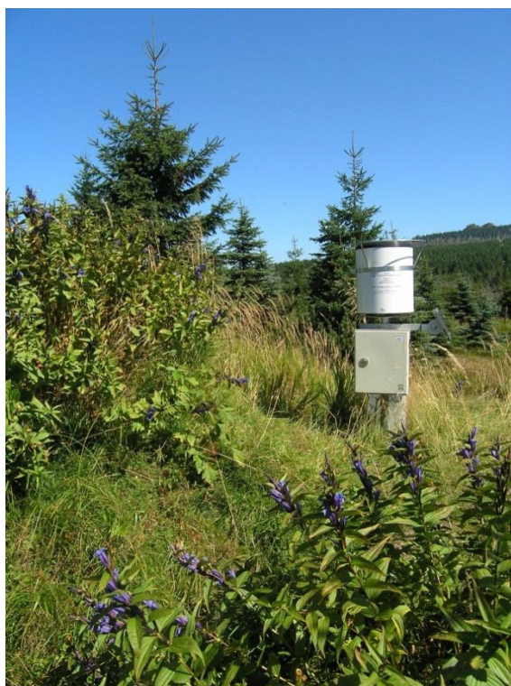
6.15 Srážkoměr v lokalitě Knajpa, srážkoměr MR 3 se záchytnou plochou 50 cm 2 a dálkovým přenosem dat.
