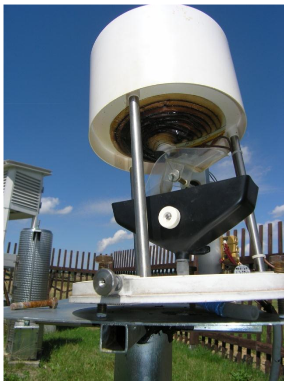
6.16 Detail překlápěcího mechanismu srážkoměru
