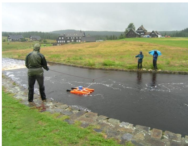
6.12 Měření průtoků přístrojem ADCP na laně
