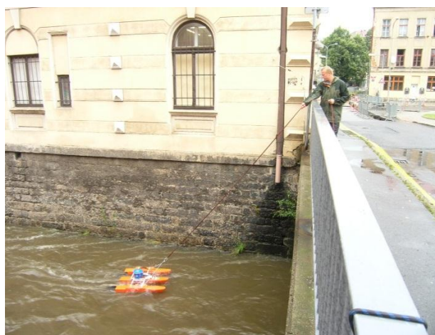
6.6 Měření průtoků přístrojem ADCP na laně z mostu. Nisa v Liberci 21.7.
