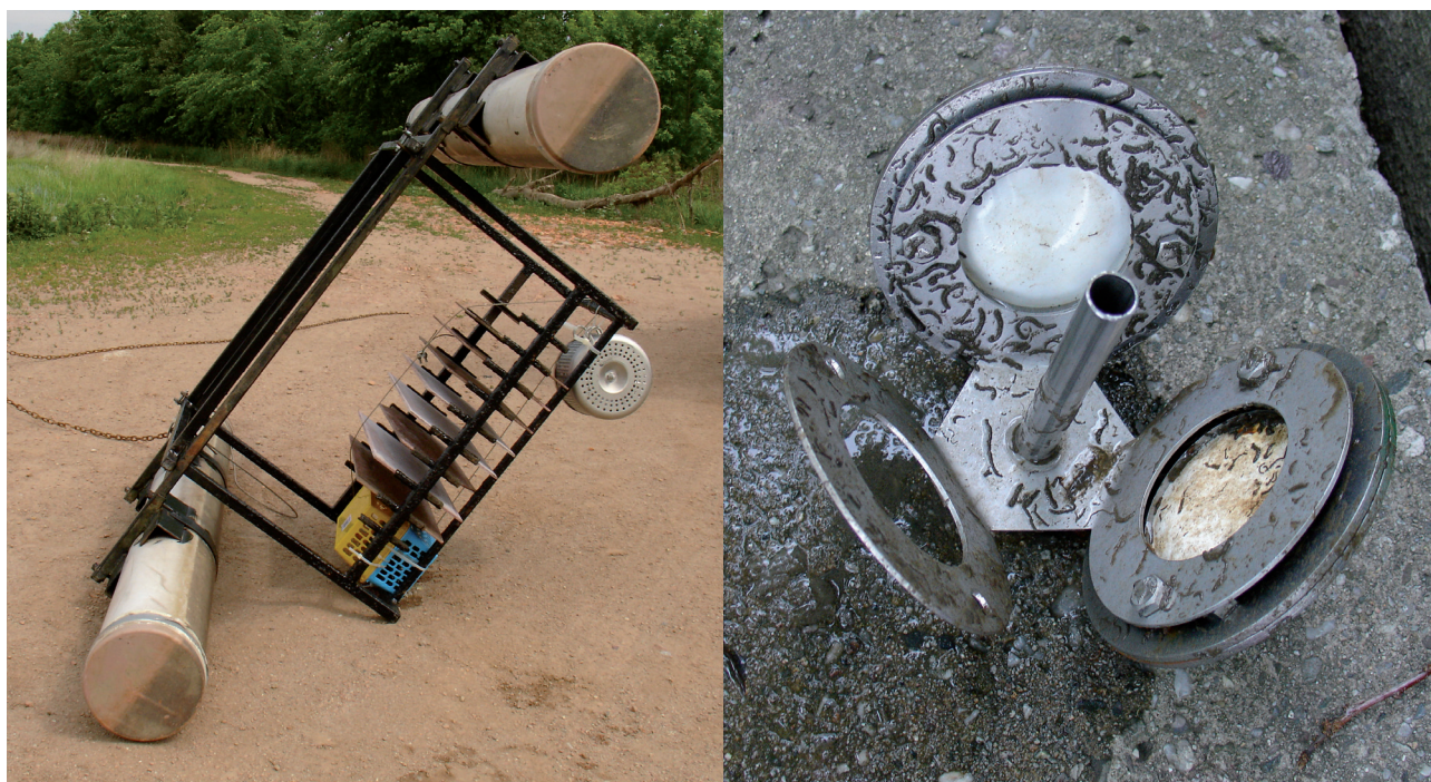
Obr. V.14 Instalace pasivního vzorkovače v ochranném koši na plováku, exponovaný vzorkovač. Fig. V.14 POCIS sampler ready for deployment, sampler after deployment.
