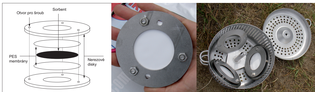
Obr. V.13 Schéma konstrukce vzorkovače POCIS, pasivní vzorkovač POCIS, vzorkovač v ochranném koši. Fig. V.13 POCIS sampler design, POCIS sampler, sampler in a protective container.
