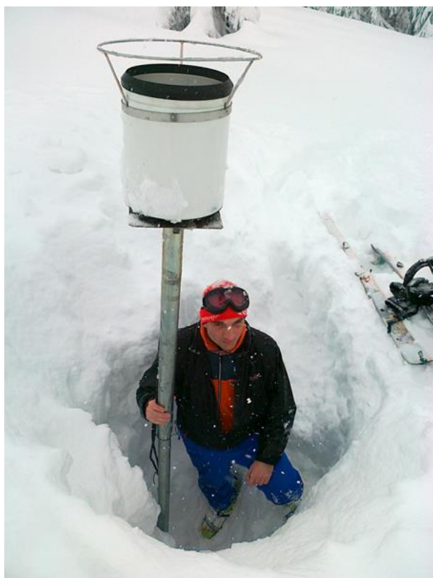
6.8 Zvedání srážkoměru na Dvoračkách
