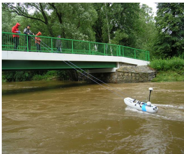
6.24 Měření povodňových průtoků Son.Tecem v Předláníčích 26.6.2013
