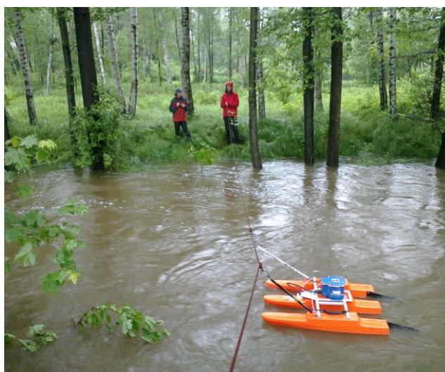
6.22 Měření vysokých průtoků na Řasnici 3.6.
