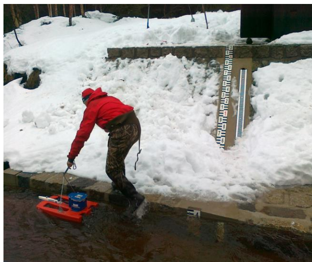
6.4 Měření průtoku na Černé Smědě 4.1.2013.
