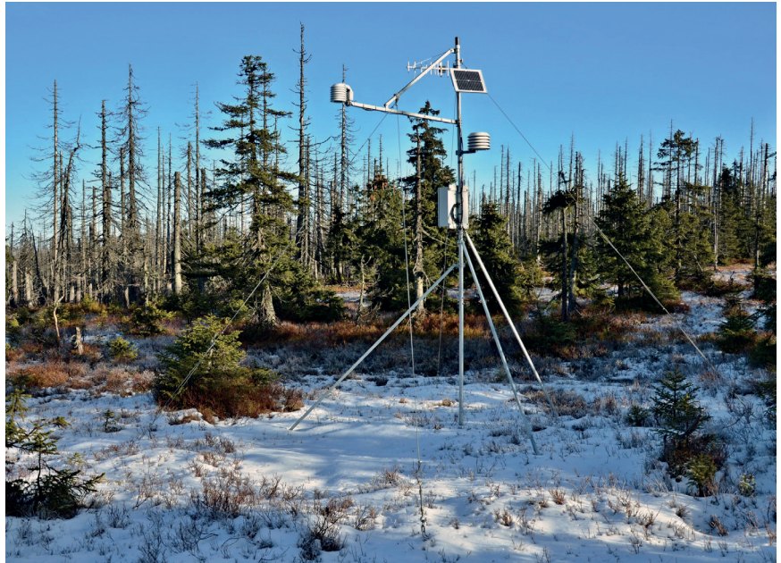
Obr. V.10 Automatická sněhoměrná stanice měřící výšku sněhové pokrývky pomocí ultrazvukového čidla. Lokalita: Plechý na Šumavě.
