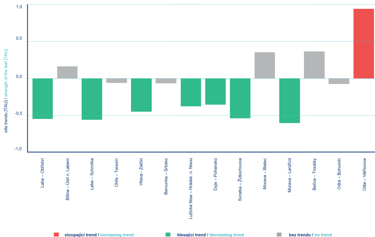
Obr. III.3.15 Přehled profilů s rostoucím a klesajícím trendem koncentrací rtuti v sedimentovatelných plaveninách. Fig. III.3.15 Summary of profiles with increasing and decreasing trend of mercury concentrations in suspended particulate matter.
